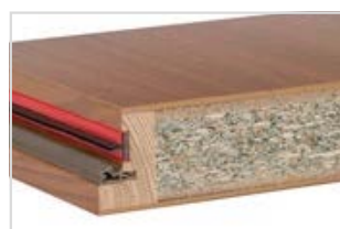
špeciálna výplň HALSPAN doskou: 44 mm [EI30] / 54 mm [EI60]
